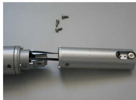
Imagem 3. Desmontagem da haste DRT
